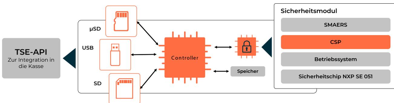
Die cryptovision TSE v2 basiert auf einer μSD-Karte mit Schnittstellen zu einer PC- oder Smartphone-Software. Sie ermöglicht den standardisierten Export von Daten im Rahmen von Außenprüfungen und Kassen-Nachschaufungen der Finanzbehörden. Die SD- und die USB-Schnittstelle werden über Adapter unterstützt.
